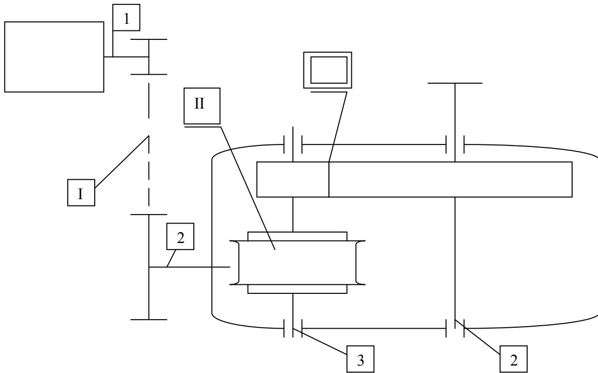
Привод состоит из электродвигателя, ременной передачи — I и двухступенчатого червячно-цилиндрического редуктора: с червячной передачей — II и цилиндрической передачей — III. Как и ранее пронумеруем валы арабскими цифрами.
