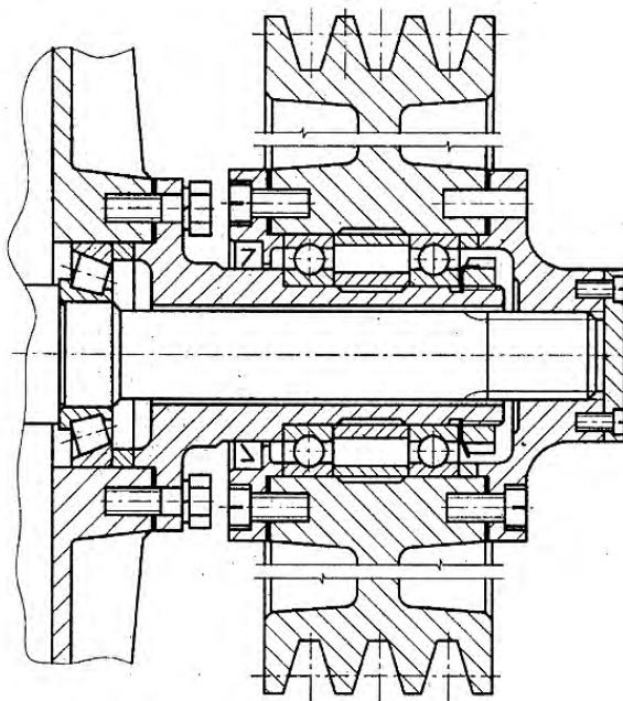
Рис. 7.4 . Конструкция шкива, разгружающая вал от напряжений изгиба
